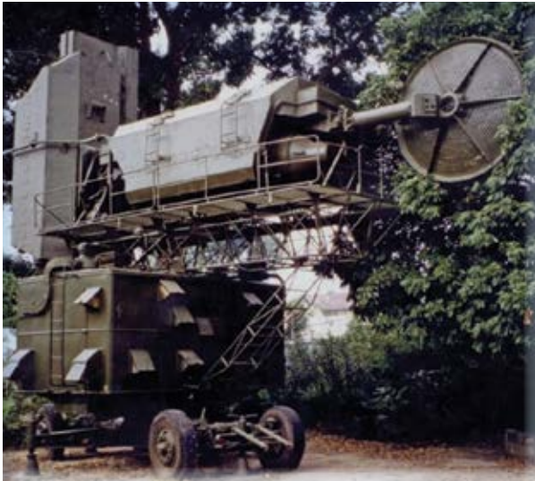
Η «καρδιά» του συστήματος S-75, το συρόμενο radar ιχνηλάτησης κι ελέγχου πυρός SNR-75, εδώ στην έκδοση M (NATOϊκή κωδικοποίηση: "Fan Song B").
